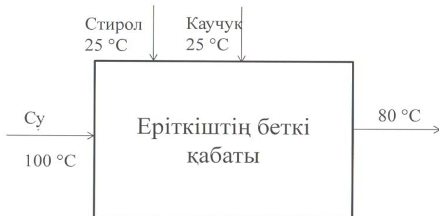
2.4 Сурет – Еріткіштің беткі қабаты басқару объектісі ретінде
